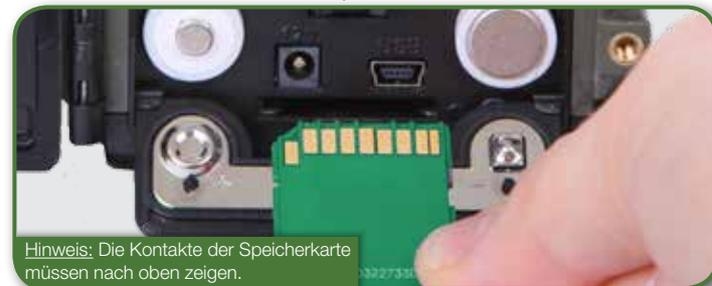
**Achtung:** Aufnahmen und auch Einstellungen im Menü sind nur mit eingelegter Speicherkarte möglich. Es werden SD-/SDHC-Speicherkarten bis zu einer Kapazität von 32 GB unterstützt.
