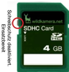
**Schreibschutz-Schalter:** An der Seite jeder Speicherkarte befindet sich ein kleiner Schieber für den Schreibschutz. Stellen Sie vor dem Einlegen der Speicherkarte sicher, dass der Schieber in Richtung Kartenkontakte steht. Nur dann kann die Speicherkarte von der Kamera beschrieben werden.
