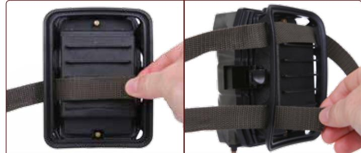
Bei einem Mast oder Baum mit großem Durchmesser: Montagegurt einmal durch Halterung ziehen.
