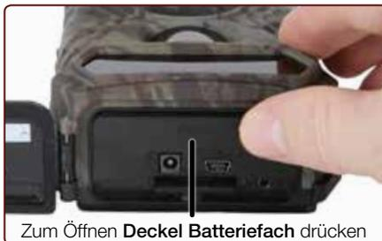
auf „PUSH“ lösen Sie die Verriegelung dieses Deckels. Achten Sie beim Einlegen der vier vollgeladenen Batterien oder Akkus bitte unbedingt auf die richtige Polarität! Diese ist im Batteriefach markiert. Verschließen Sie das Batteriefach wieder mit der Schutzabdeckung, bis der Verschluss einrastet.
