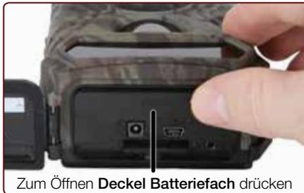
Mit leichtem Druck auf „PUSH“ lösen Sie die Verriegelung dieses
