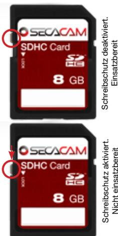
dass der Schieber in Richtung Kartenkontakte steht. Nur dann kann die Speicherkarte von der Kamera beschrieben werden.
